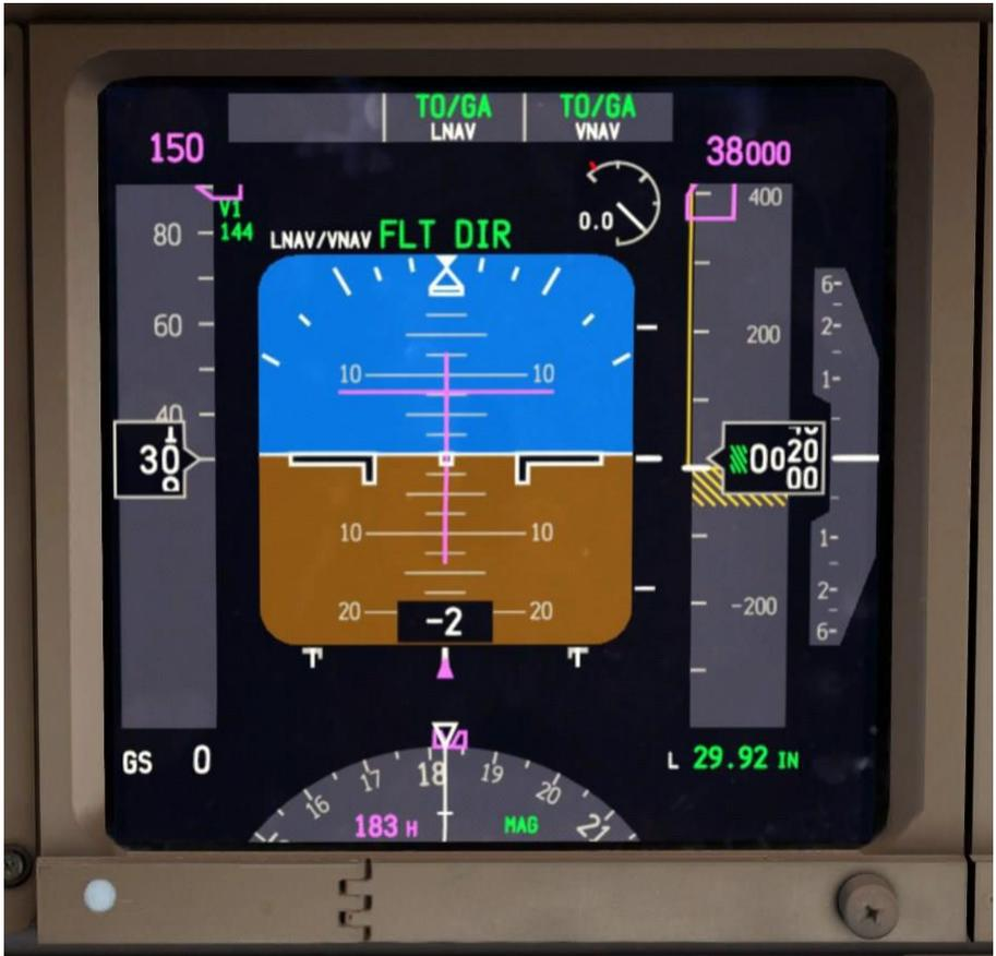
Note pour plus tard il y a des conditions où **LNAV** ne se réarme pas sur le terrain, notamment si le cours de la première étape est plus de **5 degrés** par rapport au cap de piste.
