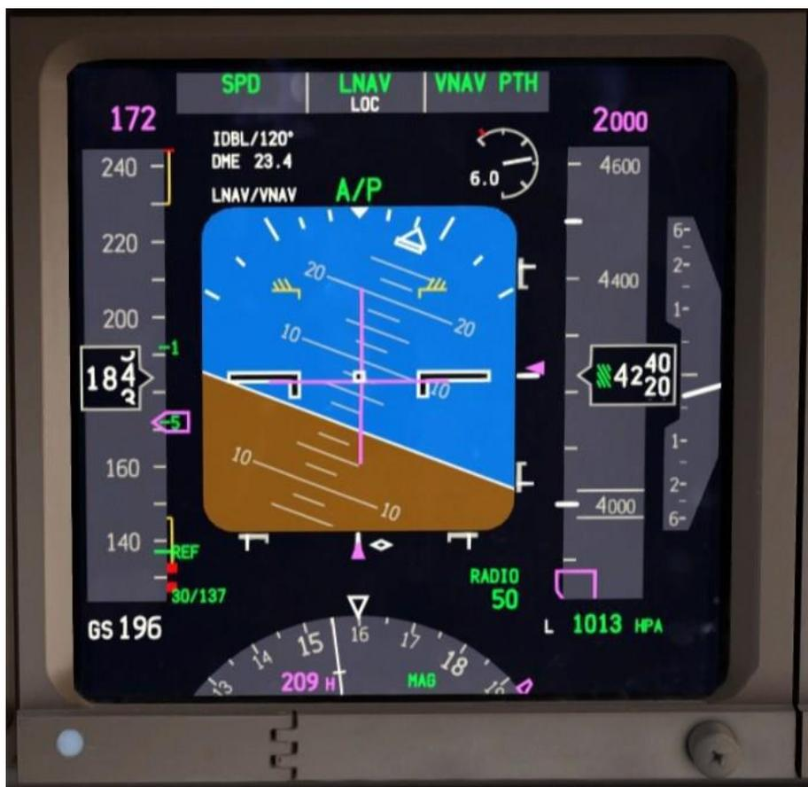
C'est toujours une bonne idée d'intercepter l'alignement avant le glideslope - en fait, les options de configuration en particulier sur le **PMDG 777-200LR / F** ne permettent pas que la **GS** soit interceptés avant le **LOC**. Nous sommes également trop loin pour capter le signal **GS**. (FSX a malheureusement des portées radio **ILS** inférieurs au réel)
