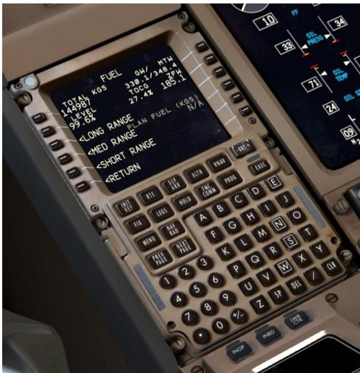
La page de carburant est notre outil de chargement et de déchargement du carburant à partir du **PMDG 777-200LR/F**. Les invites sur le côté gauche vous permettent de charger le combustible comme un poids total, un pourcentage total, ou dans les niveaux prédéfinis conçus pour des types spécifiques de vols.
