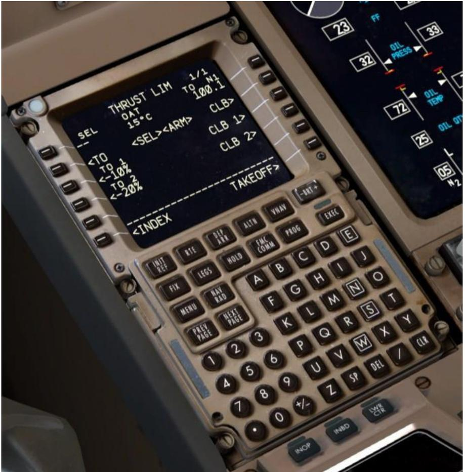
La page **THRUST LIM** contrôle le ratio de poussée des moteurs au décollage et à la montée initiale.
