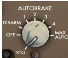
**RTO** est synonyme de décollage interrompu et appliquera automatiquement le freinage maximal dans le cas où les manettes sont ramenées au ralenti tout-ou-dessus de **85 nœuds** pendant la course au décollage.
