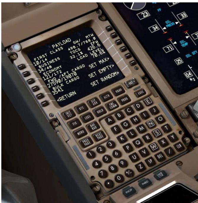
La page **PAYLOAD** est similaire à la page de carburant, mais pour les passagers et le fret. Les invites sur le côté inférieur droit sont des présets de charge rapide. Sur le côté gauche vous pouvez taper et sélectionner la ligne avec le nombre exact de passagers en premières et en classe économique, le poids de la cargaison dans les compartiments de l'avant, à l'arrière et en vrac qui sont assis dans la cabine passagers.
