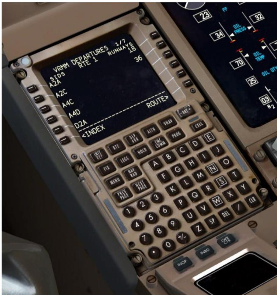
La page **VRMM DÉPARTS** contient toutes les pistes et les départs normalisés aux instruments (**SID**) pour **MALÉ** qui existent dans la base de données de navigation du **FMC**.
