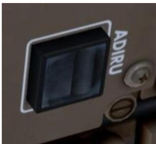
Cela coupe les gyromètres laser de l'unité de référence inertielle. Ils vont maintenant perdre l'alignement et nous aurons besoin de les réaligner complètement pour obtenir nos écrans normaux.
