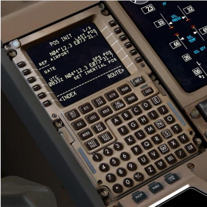
La page **POS INIT** est utilisée lors d'un démarrage **cold and dark** pour fournir une position initiale pour les données inertielle de référence (**ADIRU**) des gyroscopes pour s'aligner. Lors du chargement du vol libre comme nous l'avons fait dans ce tutoriel, l' **ADIRU** est déjà aligné, si cette page n'est pas réellement une fonction tangible dans ce contexte et une entrée n'est pas nécessaire.
