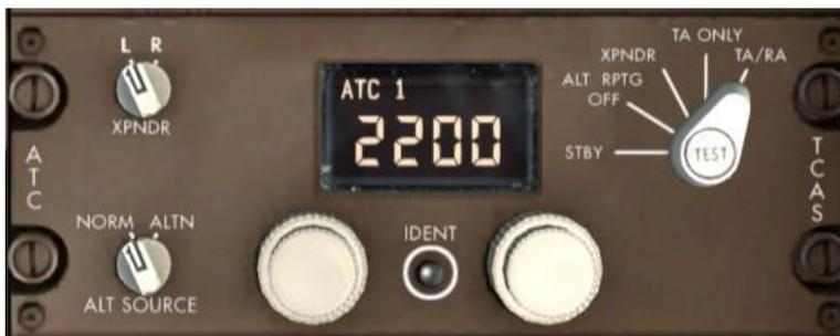
Le sélecteur de mode de transpondeur est réglé par défaut sur **TA/RA** dans le 777, comme cela est couramment utilisé même sur le terrain maintenant puisque la plupart des 777 des aéroports fonctionnent à l'utilisation du matériel de détection de surface pour l'aéroport (**ADSE**) pour suivre les avions au sol.
