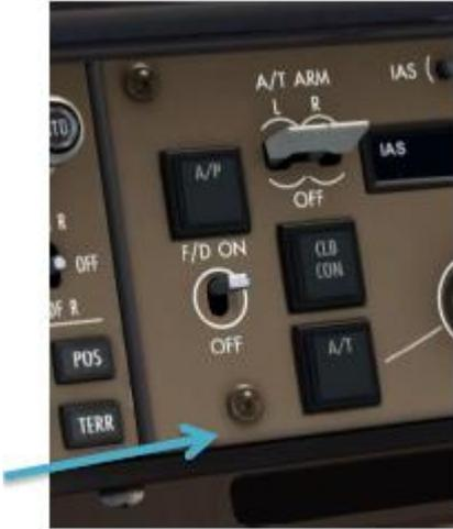
**Remarque**, le **TO/GA** vis clickspot possède une nouvelle fonctionnalité dans le **PMDG 777-200LR/F** par rapport aux produits de PMDG passées. Un clic gauche engagera le **TO/GA**, un clic avec la molette déconnecte l'autothrottle (comme le bouton sur le côté des leviers de poussée) et un clic droit va déconnecter le pilote automatique. (Comme le bouton sur le yoke)
