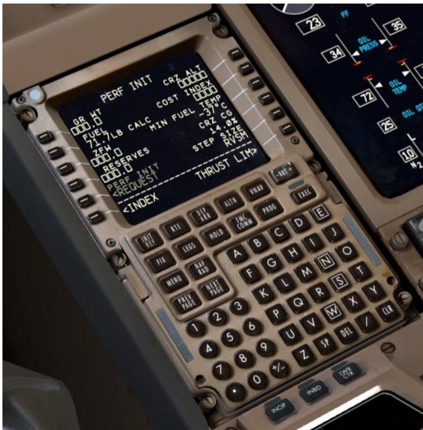
La page **PERF INIT** est l'endroit où l'équipage indique au **FMC** les masses d'exploitation de l'aéronef et les paramètres qui influent sur les performances de la route vertical et le **COST INDEX**. C'est aussi là où l'altitude de croisière de l'avion est réglée.
