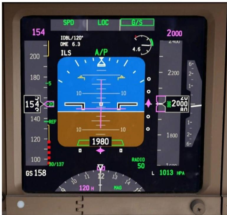
Contrairement à d'autres avions Boeing ou vous pouvez être habitué, le 777 ne nécessite pas de procédures supplémentaires à configurer pour un atterrissage automatique. Les modes **G/S** et **LOC** entraîneront toujours un atterrissage automatique sauf indication contraire par une action du pilote.
